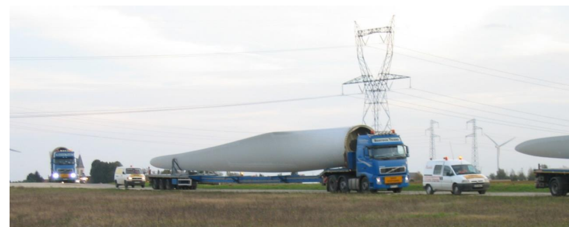
Figure 68 : Illustration du transport des pales (©ATER Environnement)
