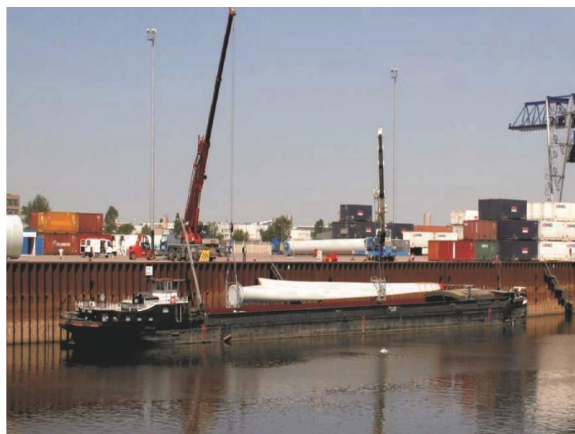
Figure 69 : Acheminement d'une pale par bateau (©ATER Environnement)
